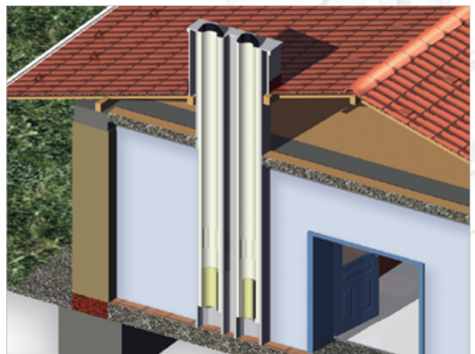
ArchiCAD-ben renderelt Absolut kéményrendszer metszeti képe:
